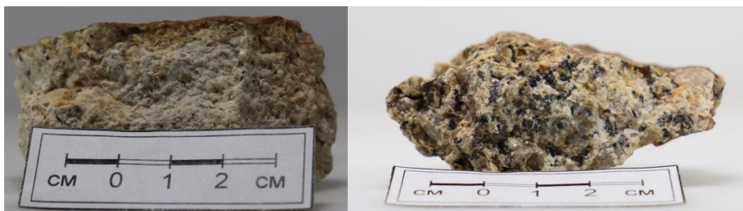
Рисунок 1. Макрофотографии изучаемых образцов; Фигура А – образец 4055/2 – плагиогранит; Фигура Б – образец 7587/1/1 – биотитсодержащий плагиогранит
